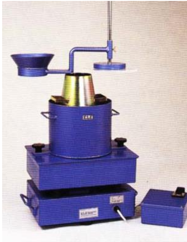
شكل رقم (8) جهاز إعادة التشكيل Vebe
