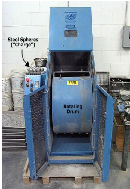
شكل (3) جهاز فحص التآكل للركام (جهاز لوس انجلس)
