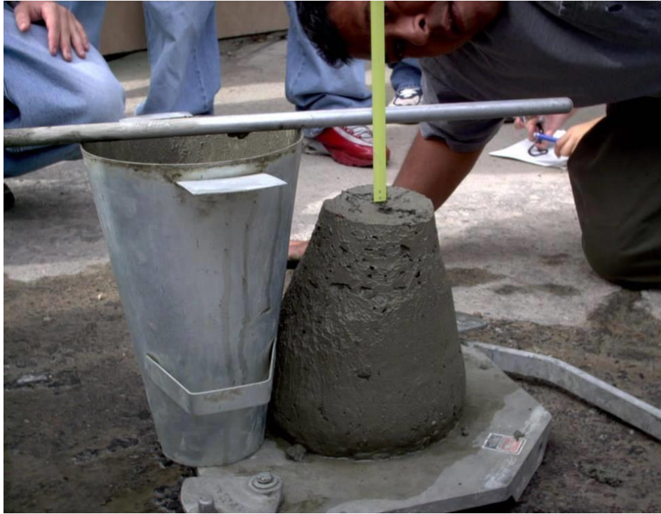
شكل رقم (3) قياس الهبوط لتحديد قوام الخرسانة الطرية
