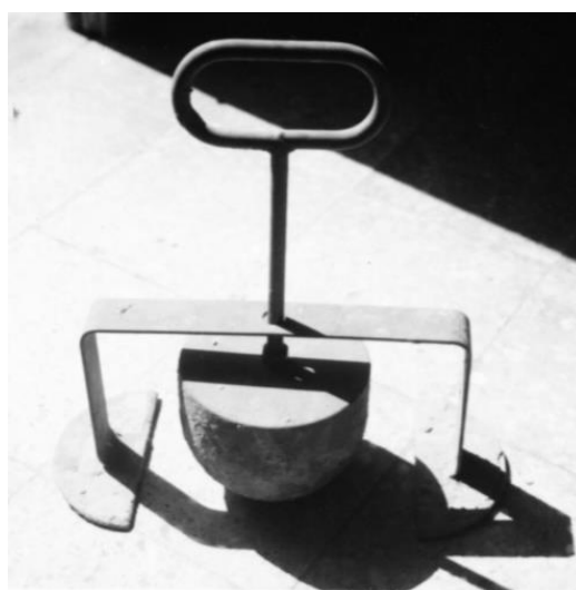
شكل رقم (6) جهاز كرة كيللي لقياس القوام
