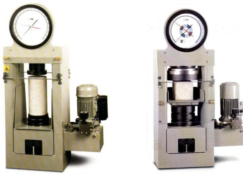
شكل رقم (6) وضع للعينات المكعبة والاسطوانية في ماكينة الضغط
