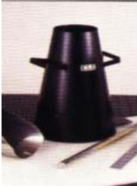
شكل رقم (1) قالب اختبار الهبوط وقضيب الرص
