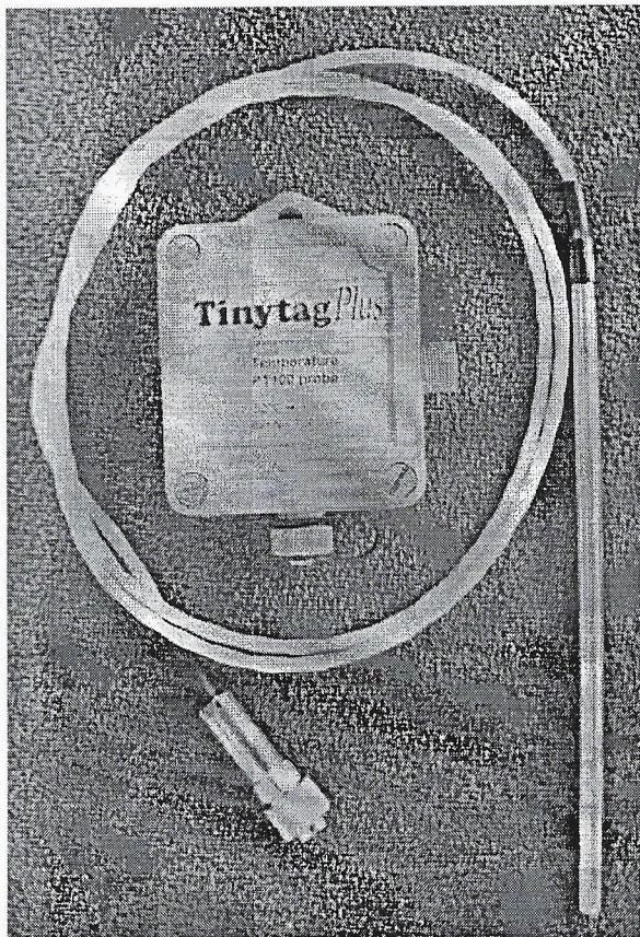
الشكل (13.6) جهاز قياس درجة النضوج
