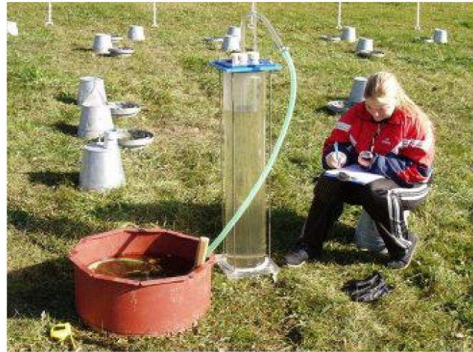
شكل ( ) . طريقة قياس معدل الترشيح.
