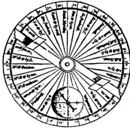
شكل ٢-٢) جهاز الاسطرلاب لقياس الزوايا
