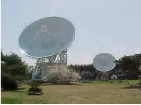
شكل ٧-٢ () هوائيات تحديد المواقع بتقنية VLBI
