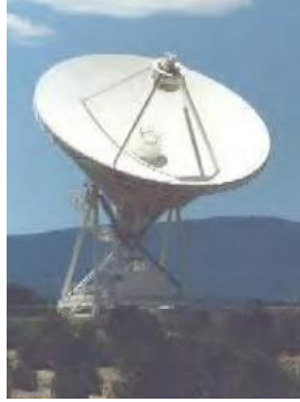
شكل ٧-٢ () هوائيات تحديد المواقع بتقنية VLBI
