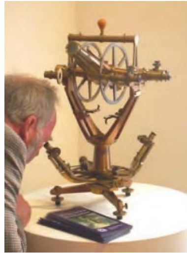
شكل ٢-٣) نماذج لأجهزة ثيودوليت قديمة لقياس الزوايا
