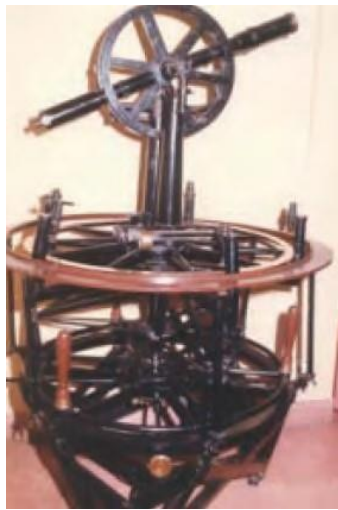
شكل ٢-٣) نماذج لأجهزة ثيودوليت قديمة لقياس الزوايا
