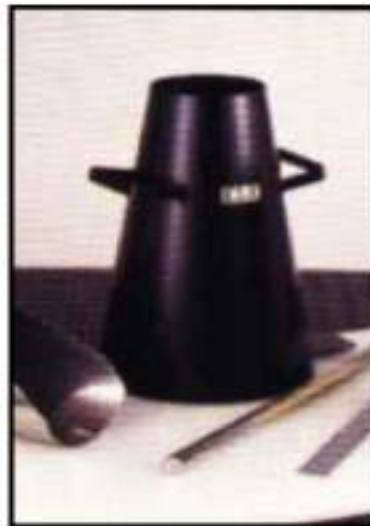
شكل (٢) قالب اختبار الهبوط وقضيب الدمك.
