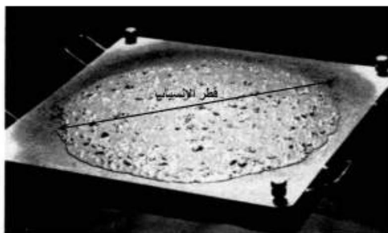
شكل (٧) انسياب المهبوط في الخرسانة ذاتية الدمك.
