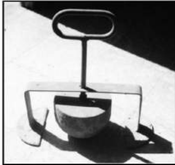
شكل (٩) جهاز كرة كيلبي لقياس القوام.
