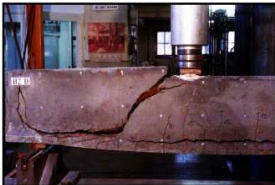
شكل (٢٩) انهيار قص (شد قطري) في كمرّة او عتبة من الخرسانة المسلحة بدون اتلاري.
