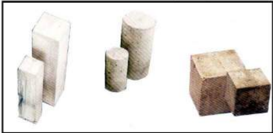
شكل ( ١١ ) الأشكال المختلفة من العينات الخرسانية المستخدمة في الضغط.
