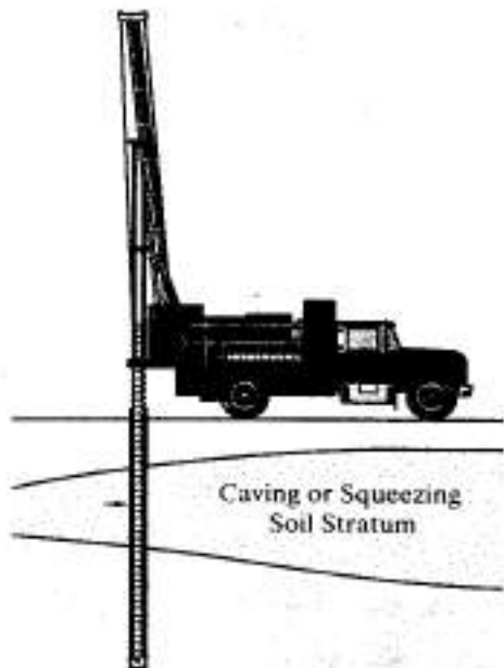
Power driven auger (Coduto, 2013)
