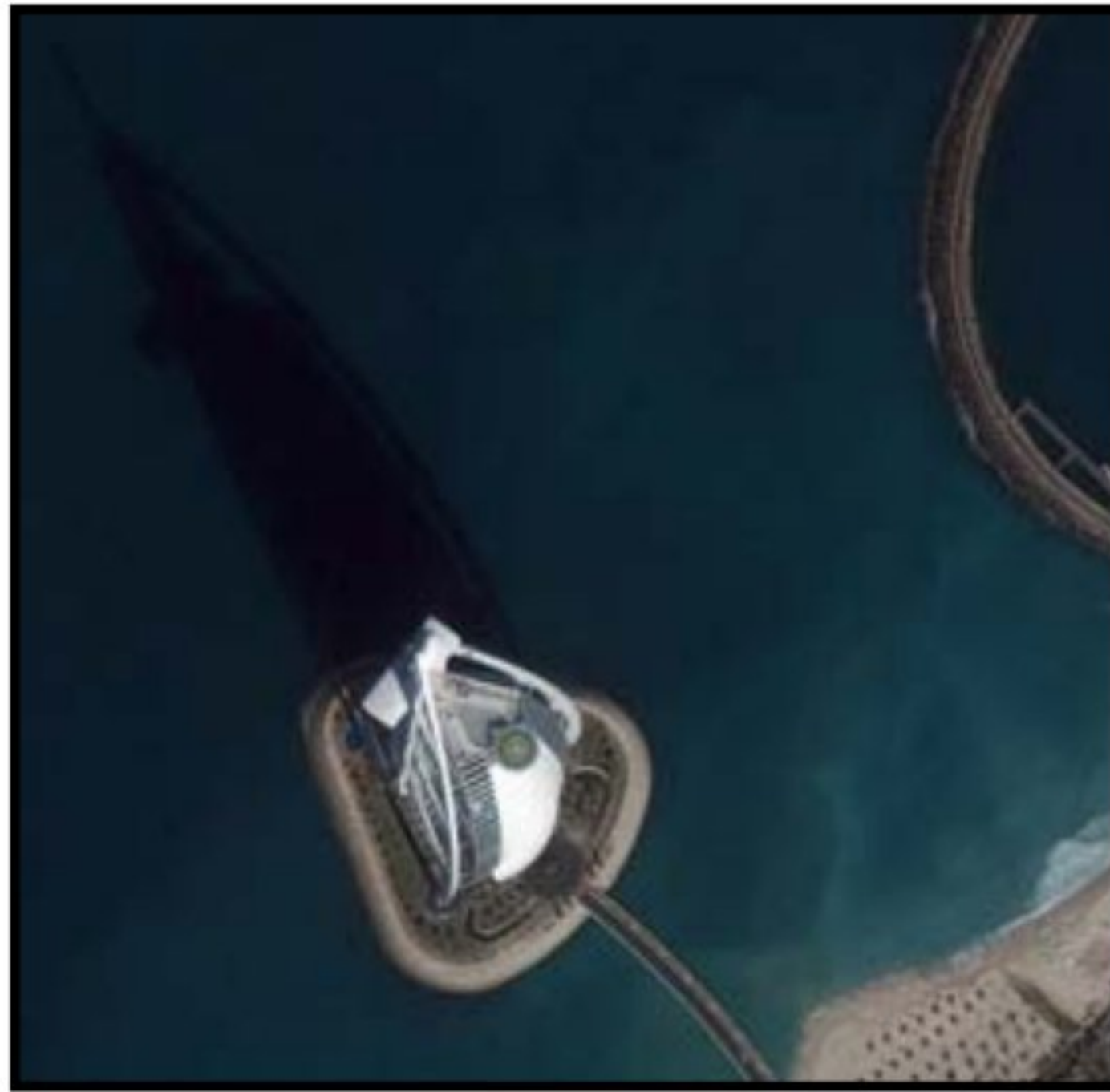
شكل (٢ - ١٨): استخدام خاصية الظل لمعرفة تفاصيل الأجسام - برج العرب دبي.
