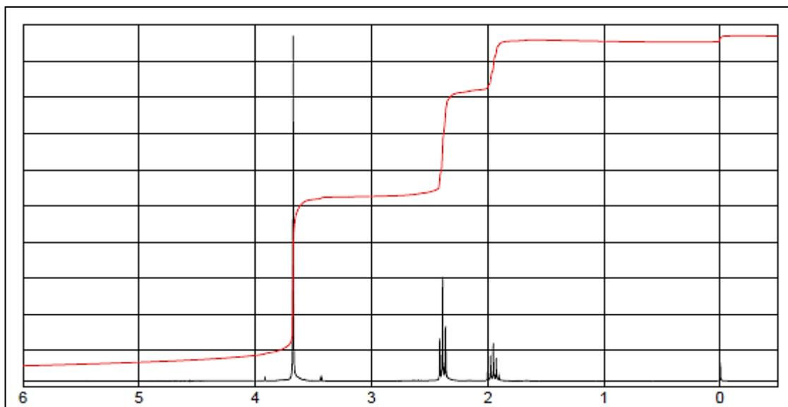
ايضاً المركب  $\text{MeOOC-CH}_2\text{CH}_2\text{CH}_2\text{CH}_2\text{-COOME}$  dimethyladipate يعطي اشارة ثلاثية عند 1.7 ppm للبروتونات الاربعة لمجموعي المثلين الوسطية، واخرى ثلاثية عند 2.4 ppm تعود للبروتونات الاربعة لمجموعي المثلين الطرفية في مذيب  $\text{CDCl}_3$  عند 300MHz وكما موضح في الشكل التالي
