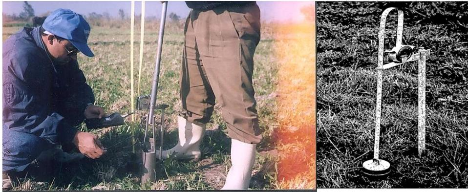
صورة رقم (2) قياس معامل النفاذية بالحقل
