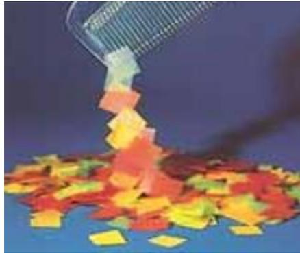
شكل 1 (التصاق ثابت) ، ظاهرة كهربائية تصاحب الطقس الجاف ، تجعل هذه القطع من الورق تلتصق ببعضها البعض وبالمشط البلاستيكي ، او تلتصق ملابسك بجسمك.
