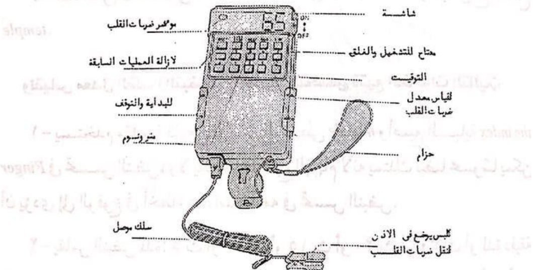
(شكل ٢،٢) يبين جهاز حساب معدل القلب الإلكتروني عن طريق مشبك يوضع في صوان الأذن
