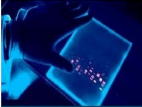
بعد انتهاء وقت التصبيغ ينقل الهلام برفق من حوض التصبيغ إلى Stage جهاز الأشعة فوق البنفسجية UV Transiluminator ويوضع غطاء الجهاز ثم يشغل.
