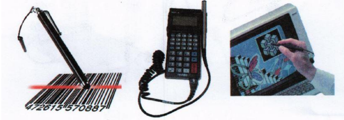
شكل ١٤ : اشكال من القلم الضوئي واستخداماته
