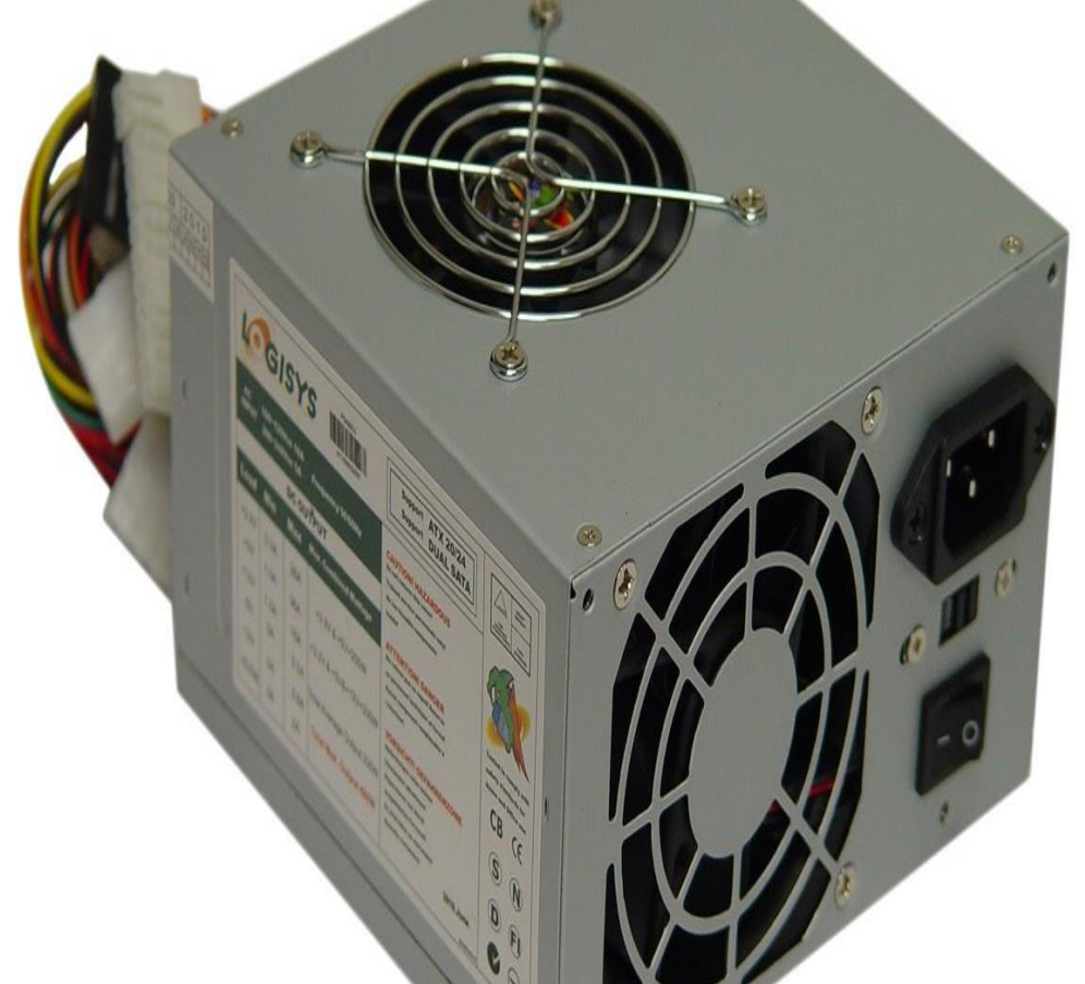
(مجهز الطاقة Power Supply)
