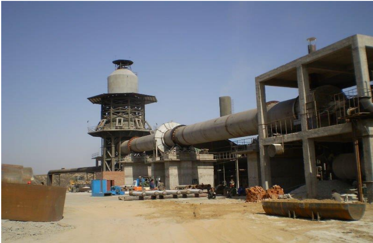
شكل رقم (1) صورة ورسم توضيحي للفرن الدوار في صناعة الاسمنت.
