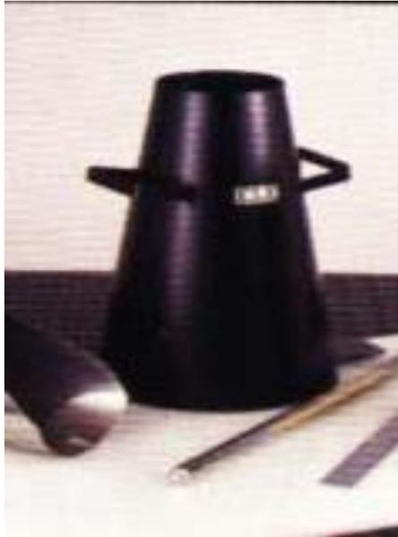
شكل رقم (1) قالب اختبار الهبوط وقضيب الرص
