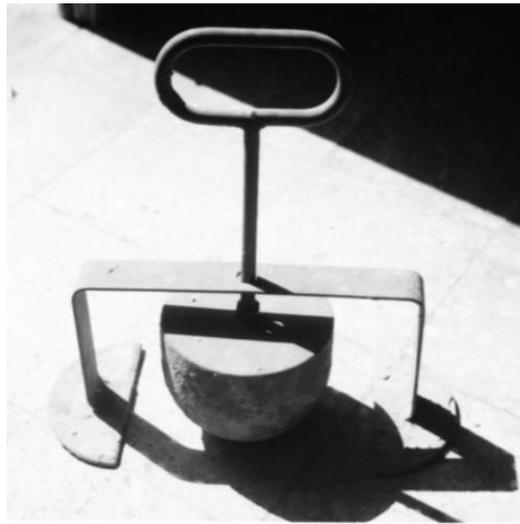
شكل رقم (6) جهاز كرة كيلبي لقياس القوام
