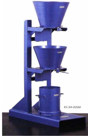
شكل رقم (7) جهاز عامل الرص
