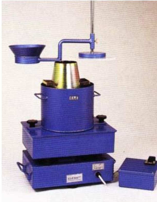
شكل رقم (8) جهاز إعادة التشكيل Vebe
