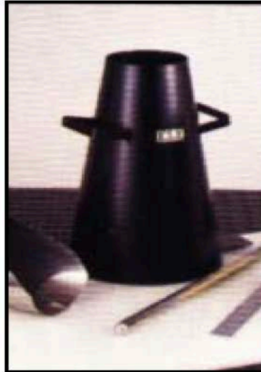
شكل (٢) قالب اختبار الهبوط وقضيب الدمك.
