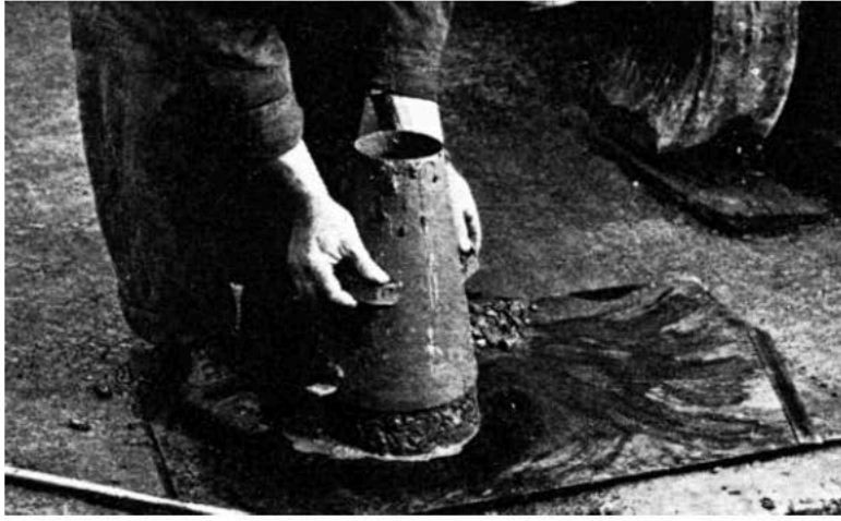
شكل (٣) رفع القالب بعد ملئه في إتجاه رأسى.
