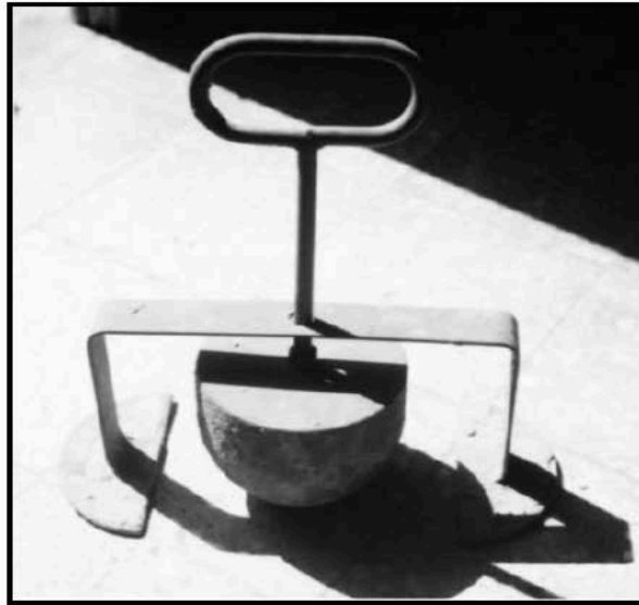
شكل (٩) جهاز كرة كيلي لقياس القوام.
