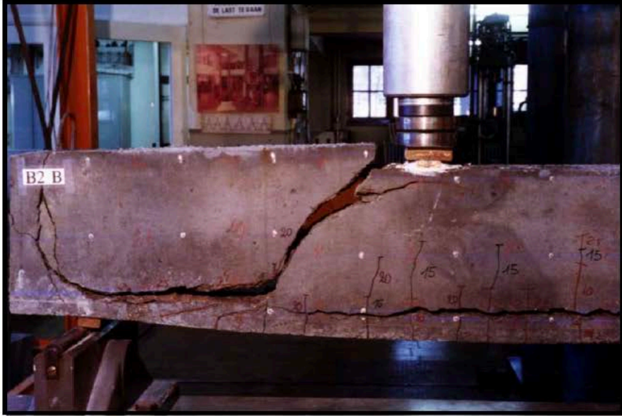
شكل (٢٩) انهيار قص (شد قطري) في كمره او عتبة من الخرسانة المسلحة بدون اتاري.
