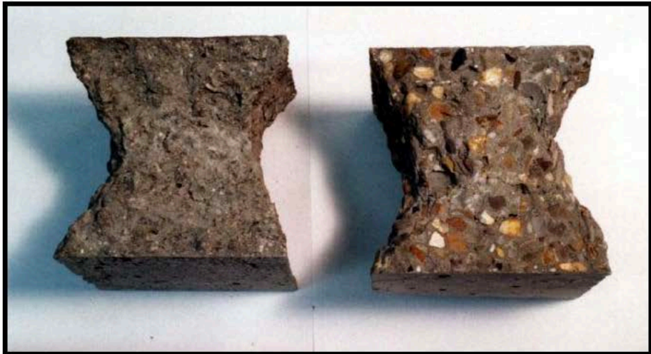
شكل ( ١٩ ) الكسر للعينات المكعبة في إختبار مقاومة الضغط .
