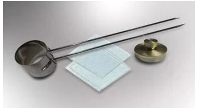
شكل وخطط جهاز لي شاتيليه المستخدم في قياس ثبوتية الاسمنت
