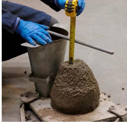
شكل يوضح طريقة قياس هطول الخرسانة الطرية
