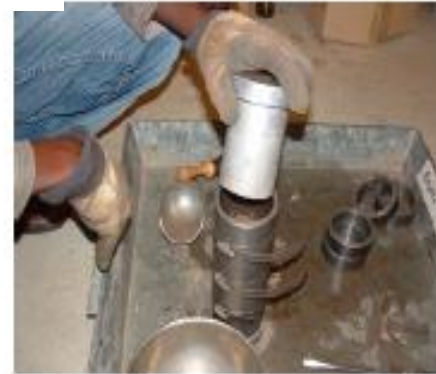
(d) Placing compaction piston
